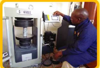
Mtaalamu wa GST akifanya vipimo vya miamba kujua kama zinafaa kwa shughuli za ujenzi
